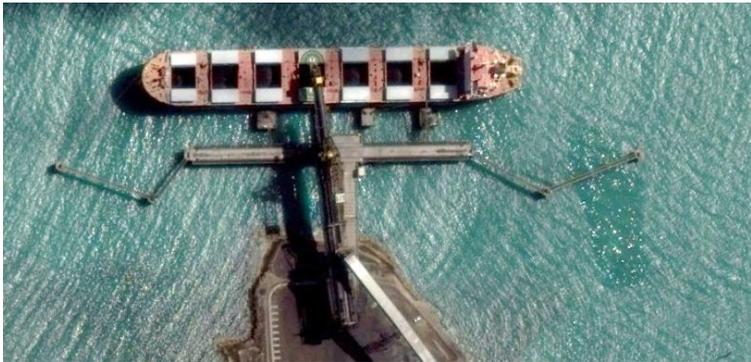
Gambar 8.6 *Linear Ship Loader* pada The Puerto Bolívar, Columbia
