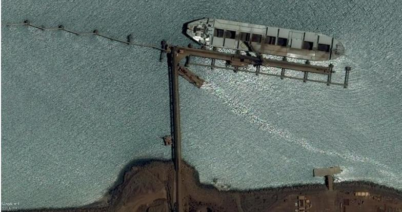
Gambar 8.7 *Traveling Loader* pada Hamersley Iron, Australia
