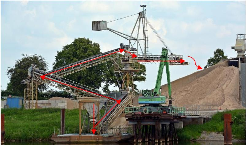
Gambar 8.13 Contoh Sistem *Conveyor* Terbuka
