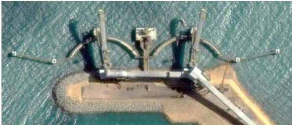
Gambar 8.3 *Radial Ship Loader* pada The Puerto Bolivar, Columbia
